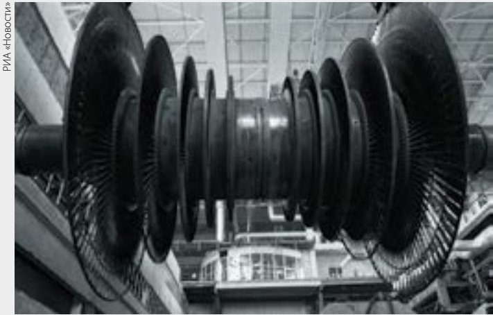
Уникальный турбинный ротор энергоблока мощностью 1200 МВт Костромской электростанции
